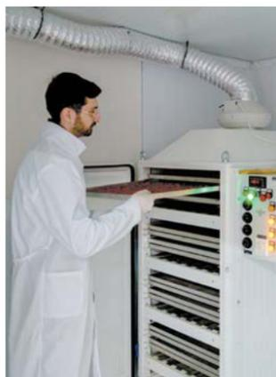
В печи продукт проводит десятки часов. Затем остывает в термокамере
