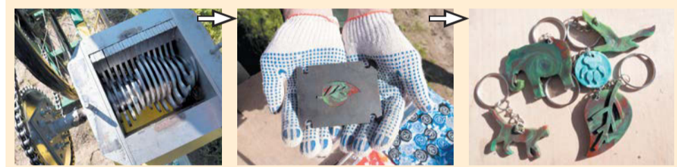
Создание брелков из пластика происходит в три этапа: дробление, плавка, залив формы
