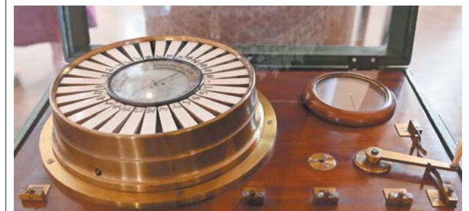
Стрелочный электромагнитный телеграф, созданный немецким предпринимателем Карлом Генрихом фон Сименсом
